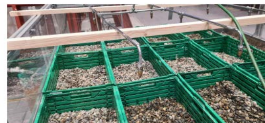
Figur 4. Ballast plassert i permeable plastkasser for enklere ombygging.
