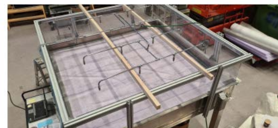
Figur 3. Testriggen for andre runde med forsøk, vinteren 2021/2022. På bildet er membran, isolasjon og geotekstil monteret, men ikke ballasten.
